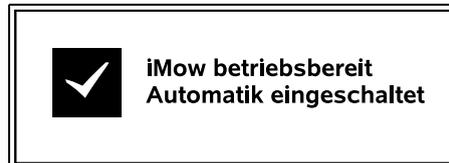
Im unteren Bereich der Anzeige werden der Text "iMow betriebsbereit" zusammen mit dem abgebildeten Symbol und der Automatik-Status angezeigt. (⇒ 11.5)
