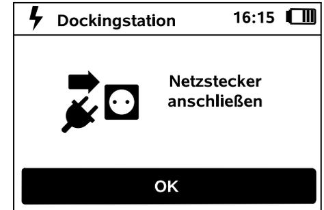
Stecker des Netzteils an Stromnetz anschließen, anschließend OK-Taste drücken.
